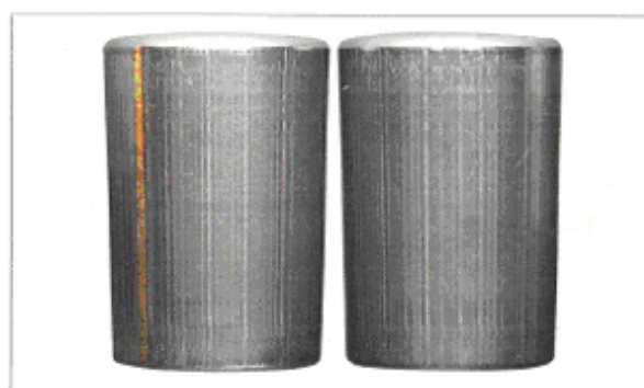
قطعه: رولرهای شکل قبل نشانه: خوردگی بصورت شیارهای موازی روی سطح رولرها
