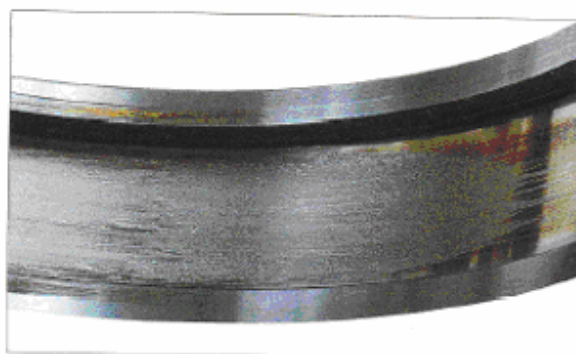
قطعه: کنس خارجی برینگ قبلی نشانه: زبرشدگی روی محیط وسطوح داخلی اتفاق افتاده علت: به دلیل زیاد بودن مقدار گریس داخل هوزینگ برینگ
