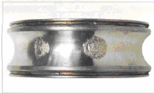
قطعه کنس داخلی یک بال برینگ شیار عمیق نشانه: پوسته شدن برینگ داخلی روی دایره گام ساجمه علت: گودی ناشی از بار ضربه ای هنگام نصب
