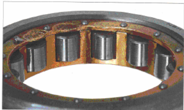
قطعه: قفسه یک رولر برینگ استوانه ای نشانه: تغییر شکل دادن قسمت سطح کناری یک کیج براسی ماشین شده مقاوم علت: شوک زیاد هنگام نصب
