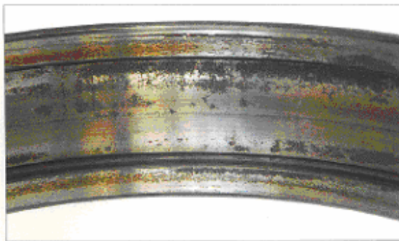
قطعه: کنس خارجی یک رولربرینگ مخروطی نشانه: زنگ زدگی روی سطح لبه ها ومحل ساچمه ها علت: نقصان روغنکاری ناشی از ورود اب
