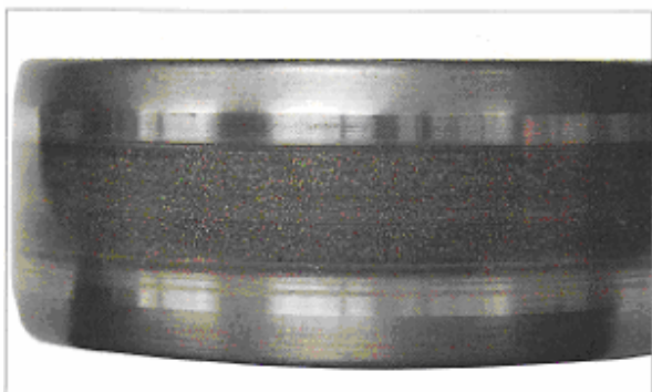
قطعه: کنس داخلی یک رولر برینگ استوانه ای نشانه: خوردگی الکتریکی نواری همراه با حفره هایی روی کنس ایجاد می کند
