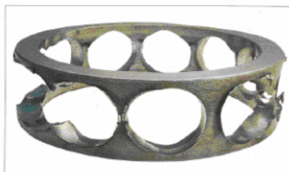
قطعه: قفسه یک بال برینگ تماس زاویه ای نشانه: شکسته شدن پایه های بین غلتک های یک کیج چدنی ماشین کاری شده علت: اعمال بار غیرعادی روی کیج ناشی از ناهم محوری بین کنس های داخلی و خارجی در زمان نصب
