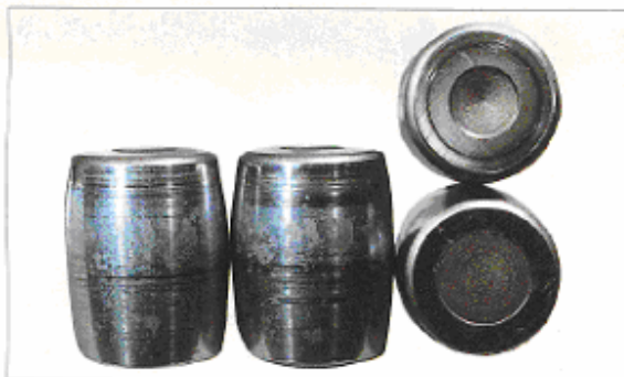
قطعه: رولرهای برینگ شکل قبل نشانه: پوسته شدن دایره ای شکل روی قسمت وسط رولرها ایجاد شده است علت: روانکاری ناقص
