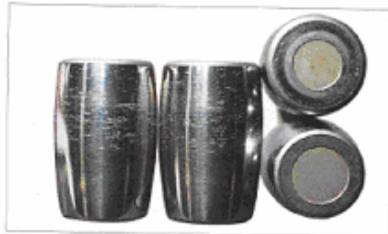
قطعه: رولرهای شکل قبلی خط افتادن روی انتهای سطوح غلنگ ها علت: تغییرات شتاب ناگهانی
