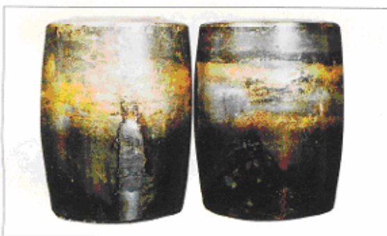
قطعه: رولرهای برینگ شکل قبل نشانه: تغییر رنگ و ذوب شدن سطح رولرها و چسبیدن ذرات فرسایشی جدا شده از قفسه روی سطح رولرها علت: روغنکاری ناقص
