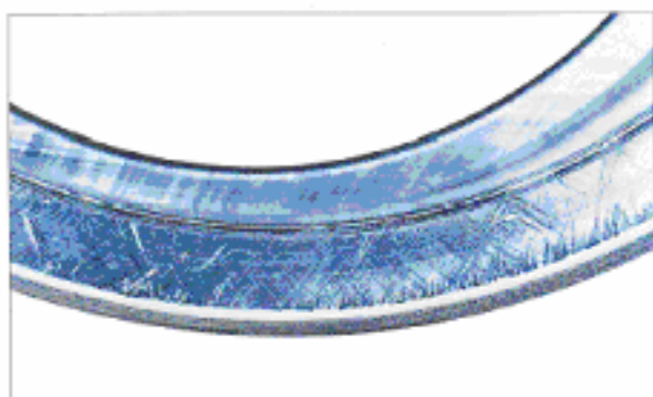
قطعه: کنس داخلی یک رولربرینگ بشکه ای نشانه: خط افتادگی راه راه روی کنس داخلی علت: گیرافتادن ذرات خارجی روی سطوح و افزایش بار محوری
