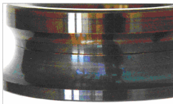
قطعه: کنس داخلی یک بال برینگ چهار نقطه تماسی نشانه: ابی یا ارغوانی رنگ شدن سطح کنس علت: حرارت تولید شده ناشی از روغنکاری ناقص
