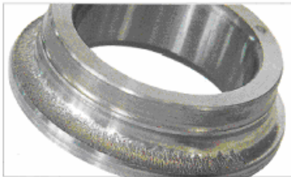
قطعه: کنس داخلی یک بال برینگ تماس زاویه ای نشانه: پوسته شدن در قسمت اطراف نیمه محل حرکت ساجمه ها اتفاق افتاده علت: روانکاری ناقص ناشی از ورود رسوبات خنک کننده به طرف هوزینگ
