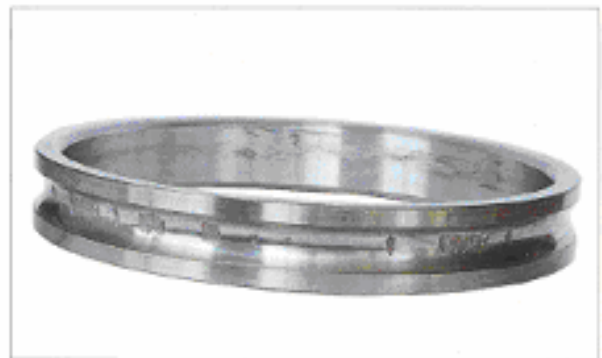
قطعه: کنس داخلی یک بال برینگ تماس زاویه ای نشانه: پوسته شدن برینگ داخلی روی دایره گام ساجمه علت: گودی ناشی از لرزش در هنگامی که دستگاه در سرویس نیوده
