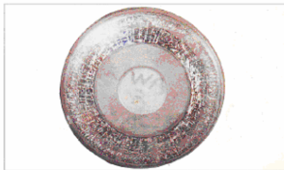
قطعه: رولرهای یک رولبرینگ مخروطی تراست نشانه: ترک های حرارتی روی سطح بزرگتر رولرها اتفاق افتاده علت: حرارت ایجاد شده ناشی از لغزیدن رولرها روی کنس داخلی همراه بار و غنکاری ناقص
