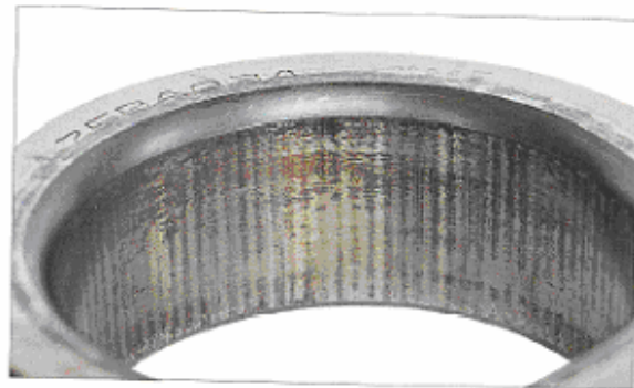
قطعه: کانس داخلی یک بال پرینگ تماس زاویه ای نشانه: توجه شود که سایش در قسمت قطر داخلی سطح ایجاد شده است علت: ناکافی بودن انطباق
