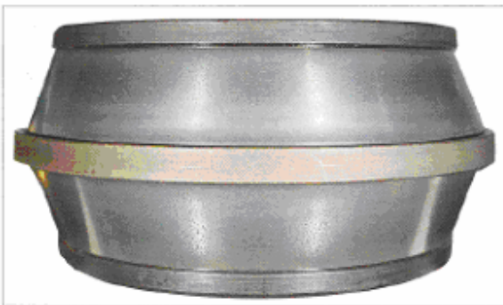
قطعه: کنس داخلی یک رولر برینگ مخروطی دوردیفه نشانه: ناصاف شدن سطح علت: گیر افتادن ذرات بین سطوح
