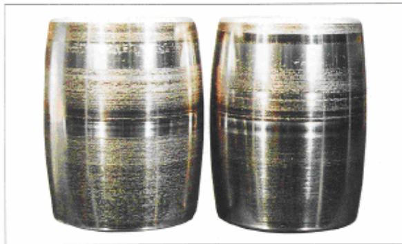
قطعه: رولرهای شکل قبلی نشانه: زبرشدگی روی مرکز سطح رولرها اتفاق افتاده است علت: روغنکاری ناقص
