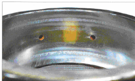
قطعه: کنس خارجی یک رولر برینگ بشکه ای نشانه: پوسته شدن در نزدیکی لبه کنس داخلی روی محیط کنس ایجاد شده است علت: روانکاری ناقص
