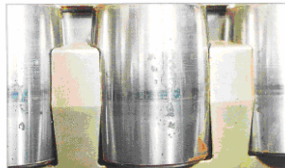
قطعه: رولرهای یک رولربرینگ بشکه ای نشانه: زنگ زدگی روی سطح تمامی ساچمه ها علت: کندانس شدن رطوبت درحین انبارداری
