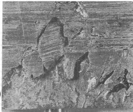
شکل ۲- خستگی ایجاد شده در اثر بارگذاری لبه‌ای روی یاتاقان ژورنال توربین بخار (الف) تصویر باز و (ب) تصویر بسته از نیمه‌ی پایینی [۳].
